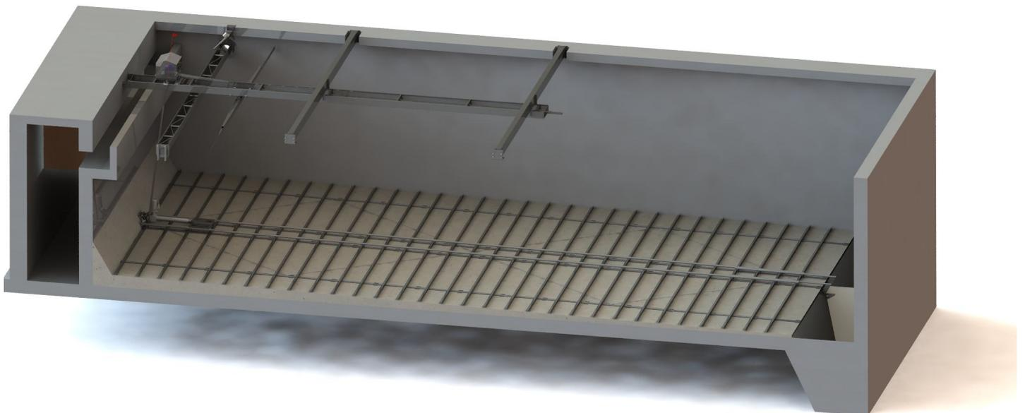
Kombination aus Bodenräumer EBS, Oberflächenräumer ESS und drehbarem Schwimmschlammrinne ERP
