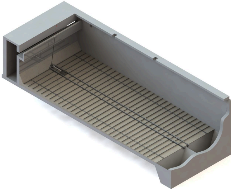
Bodenräumer HBS mit Unterwasserantrieb
